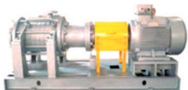
Однокорпусной многоступенчатый двухопорный с радиальным разъемом тип BB4
