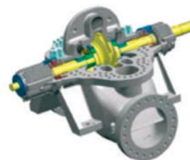
Одноступенчатый двухпорный с осевым разъемом тип BB1
